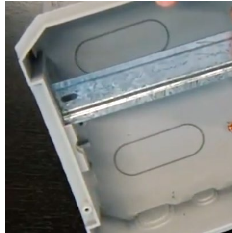
Шаг 2 Открутить саморезы и высвободить DIN-рейку
