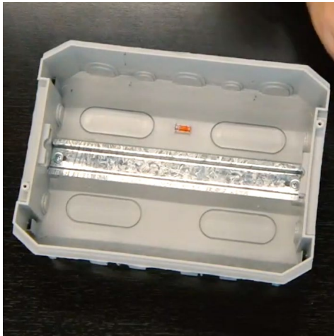
Шаг 1 DIN-рейка установлена на своем штатном месте
